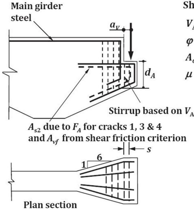
**SHEAR FRICTION REINFORCEMENT [Sec 5.8.4]**
